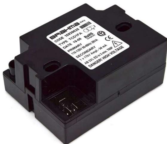
全世界の燃焼装置に幅広く使用されているイタリア・ブラマ株式会社の日本国内仕様製品です。民生用、業務用、産業用、工業加熱用ガスバーナ及びオイルバーナ用高周波パルス式点火トランスです。ノイズを最小限に抑えるためにEU規格に準拠したEMCフィルターを内蔵しており、外部フィルターは不要です。高電圧ケーブル線の接続端子はスクリー式となっており、接続後は容易に抜けにくく緩みや接触不良を防止します。
