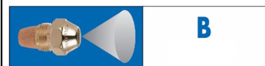
Bソリッドコーンタイプは噴霧断面で見ると「円錐内部全般に均一に液滴が噴霧されている」タイプです。流量が増加するにつれて、特に 8.00GPH を超えると、スプレーパターンは徐々に中空になります。特に大型バーナーにおいて、スムーズな点火と効率的な燃焼を実現します。
