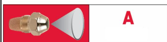
Aホローコーンタイプは噴霧断面で見ると「円錐の内側が空っぽで円錐表面側に液滴の分布している」タイプです。噴霧量は最大 2.00 GPH（約7.6 リットル/毎時）です。良好な点火と低騒音燃焼を実現します。
