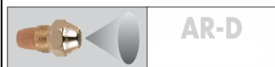
AR-Dタイプは、Bタイプに似たソリッドコーンタイプですが、コーンの中心の液滴の濃度がわずかに低くなります。低流量から中流量（最大流量 2.00GPH）までのバーナーで高い性能を発揮します。
